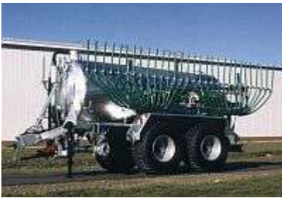
Прицепной шланговый распределитель "Vogelsang" с рабочей шириной 15 м
