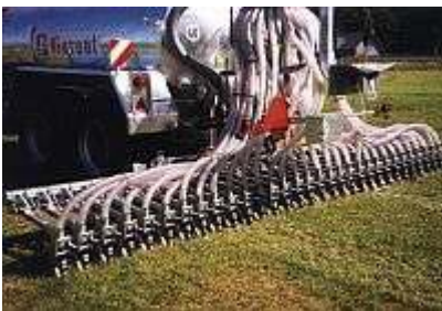
Шлицевой башмачный распределитель, система "Sloodsmid" в рабочем положении
