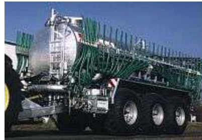
Прицепной шланговый распределитель "Vogelsang" с рабочей шириной 24 м
