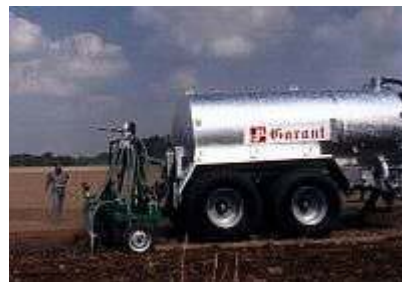
Инжекторный распределитель жидкого навоза с подрессоренными рожками с рабочей шириной 4,60м
