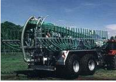
Прицепной шланговый распределитель GARANT с рабочей шириной 15 м с блокировкой подтекания путем раскрутки шлангов
