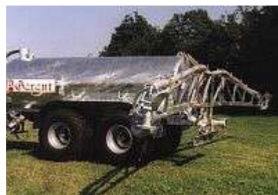
Разбрызгивающий распределитель с двумя поворотными соплами типа "Möscha" в боковых рукавах
