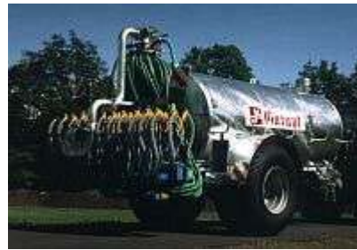
Прицепной башмачный распределитель "Bomech" в транспортном положении
