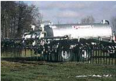
Прицепной шланговый распределитель GARANT с рабочей шириной 21 м с запатентованной блокировкой подтекания путем раскрутки шлангов
